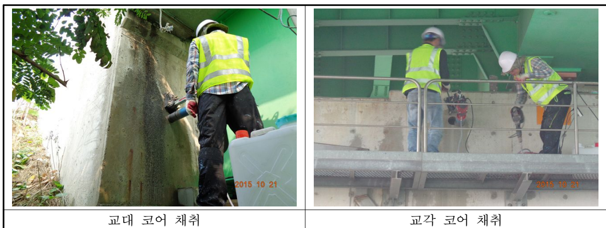
〈사진 3.21〉 압축강도 시험 현황
